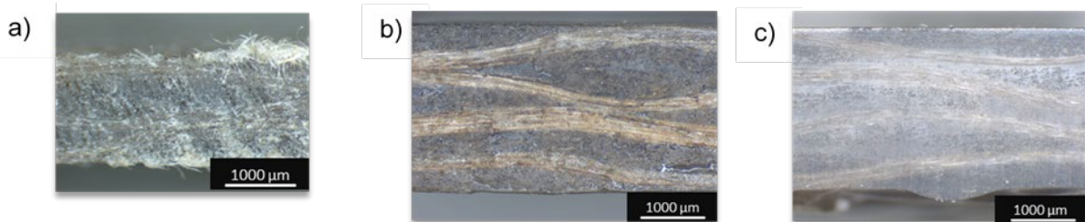
Bild 3: NFK Schnittkanten: Mechanischer Schnitt mit Fräse (a); CW-Laser-Cutting, v_c = 8.000 \text{ mm/min} (b); UKP-Laser-Cutting, v_c = 12 \text{ mm/min} (c) [9].
