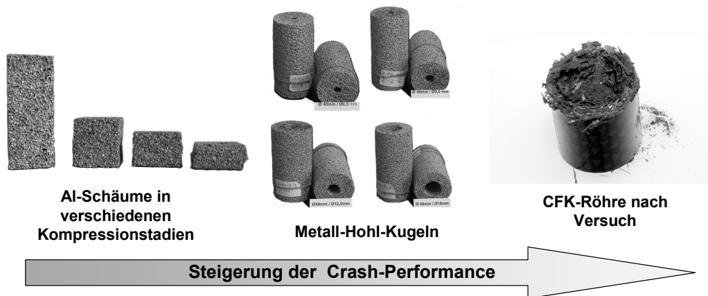
Bild 7: Exemplarische Auswahl untersuchter Energieabsorptionsmaterialien
